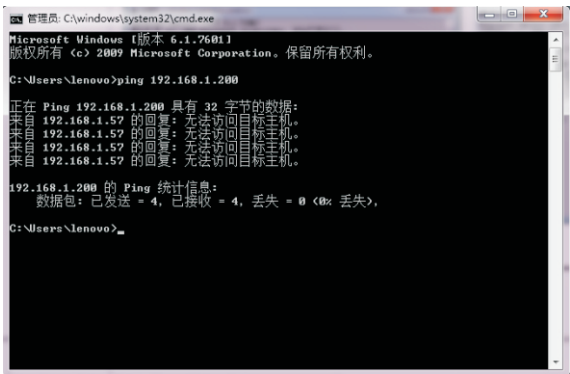
显示上面的内容说明IP地址配置错误, 请重新配置。
